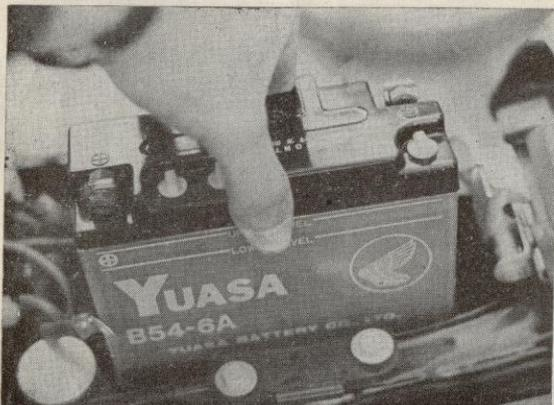
Pour contrôler le niveau d'électrolyte, il faut soulever la batterie, ce qui nécessite le débranchement des fils des bornes positive et négative du fait de leur trop faible longueur (photo RMT)
