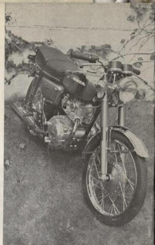
L'équipement du modèle « K 5 » est extrêmement complet. On remarque la présence du démarreur électrique sur la partie frontale du bloc-moteur (photo RMT)
